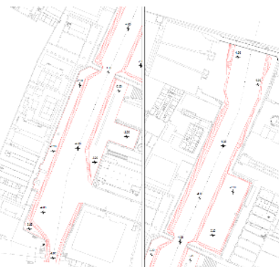
Interventi di restauro del Ponte dei Leoni. Quote di dragaggio di progetto.
